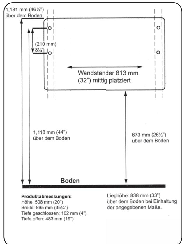
Hat die Wand Holzständer, deren Abstand zueinander nicht 32" (813 mm) beträgt, beträgt, oder Metallständer oder ist sie aus Beton, bohren Sie mit einem 1/2"-(12 mm)-Mauerbohrer. (Vor der Montage müssen Sie sich ggf. Knebel besorgen.) Planen Sie je nach Art der Knebel einen Mindestplatz hinter der Mauer ein, damit sich diese drehen können. Setzen Sie die Knebel ein und ziehen Sie sie fest.
